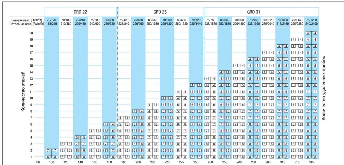
Диаграмма 2: Диаграмма для расчета линий с **двумя** вытяжными элементами на этаже
