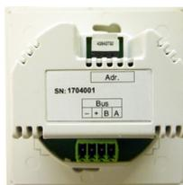
Le raccordement d'un détecteur externe câblé est réalisé sur l'interface RS-485 de la commande RLS 45 O/K (au max. 3 détecteurs par commande).
